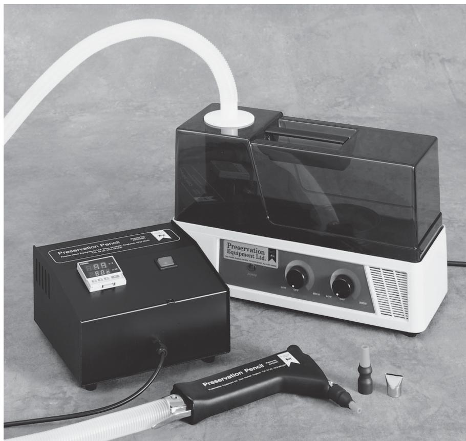
Die vom Ultraschall-Befeuchter produzierte, kalte Feuchtigkeit wird im Dampfstrahlstift erhitzt. Über eine Digitalanzeige kann jede gewünschte Dampftemperatur von Raumtemperatur bis ca. 100° eingestellt werden.
